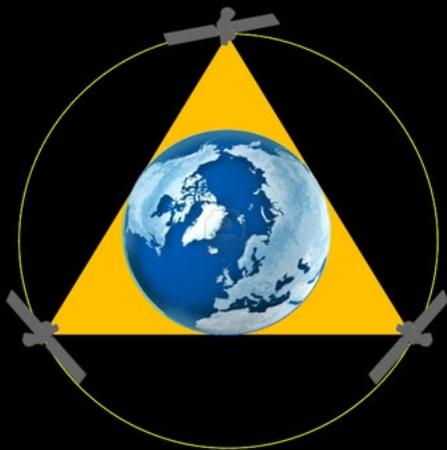
Dans le cas des télécommunications par satellites, on privilégiera l'orbite géostationnaire à 36 000 km de la Terre alignée sur la ligne équatoriale pour deux raisons:
