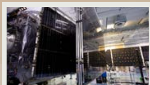
Test de déploiement de panneaux solaires de Juice
