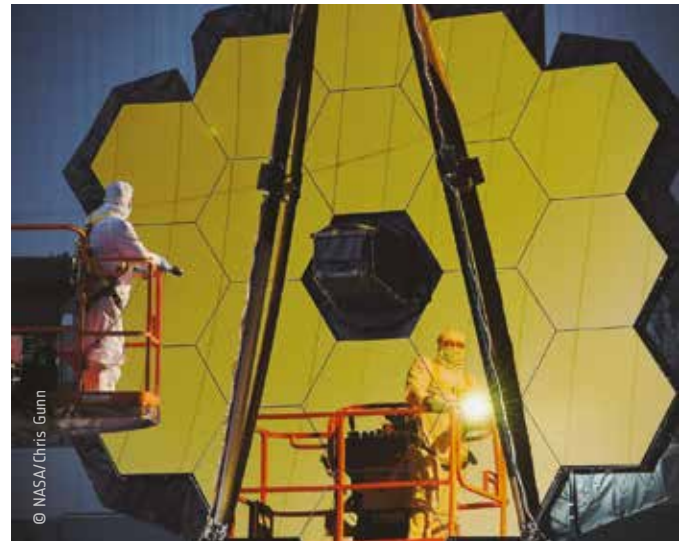
▲ Le miroir géant de Webb a subi de nombreux essais rigoureux, pour confirmer qu'il peut résister aux vibrations et aux bruits assourdissants du lancement.
